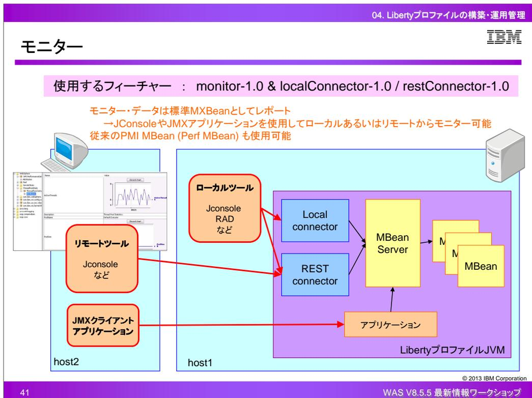
Libertyプロファイルのサーバー・ランタイム環境をモニターするためにはmonitor-1.0フィーチャーを使用します。そして、ローカルツールからモニター・データを確認するためにはlocalConnector-1.0フィーチャー、リモートツールからモニター・データを確認するためにはrestConnector-1.0フィーチャーを使用します。
