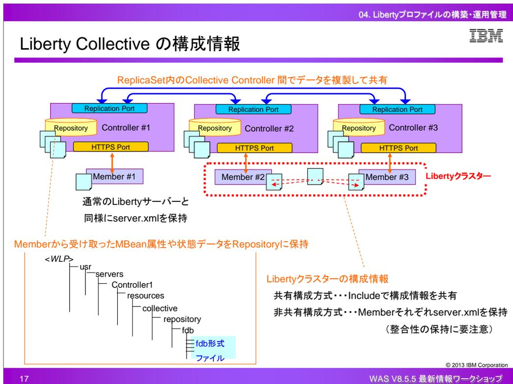
Liberty Collective 構成の場合、各Collective Member は通常のLibertyサーバーと同様に構成情報としてserver.xmlを保持しています。そして、Collective Controller は、Collective Memberから構成情報の一部やランタイム状況を受け取り、更にReplica Set のデータ複製によって受け取った情報も含めて、各Collective Controllerが保持するRepositoryに格納します。Repositoryの実態はファイル群であり、Collective Controller のサーバー情報が格納されているディレクトリ配下にfdb形式で保管されています。
