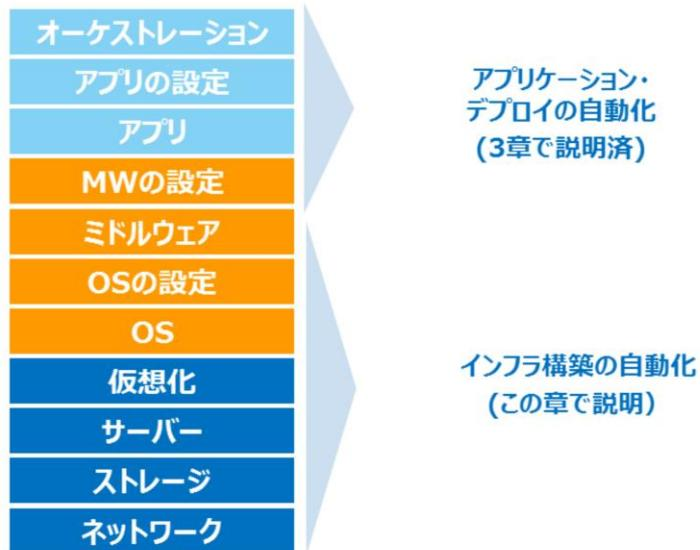
デプロイ自動化を考えた場合、大きく「アプリケーション・デプロイの自動化」と「インフラ構築の自動化」の2つに分けられます。3章ではアプリケーション・デプロイの自動化を説明しました。
