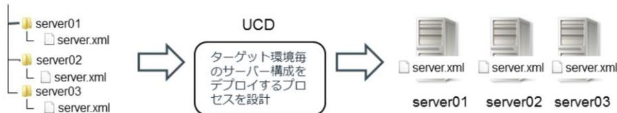
②server.xmlは共通の1つを構成管理。デプロイ実行時に、事前定義したUCDのプロパティを参照し、ターゲット環境毎に書き換えてデプロイする
